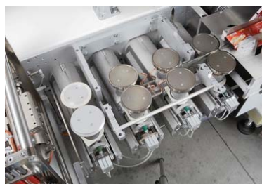
Quatre groupes indépendants de jeu de molettes avec le premier groupe inclinable
