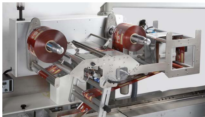
Double porte bobine à jonction automatique avec système de marquage sur machine bobine haute
