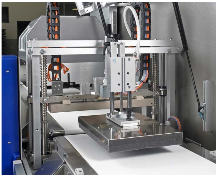
Soudure transversale à barres accompagnantes et cousin presseur
